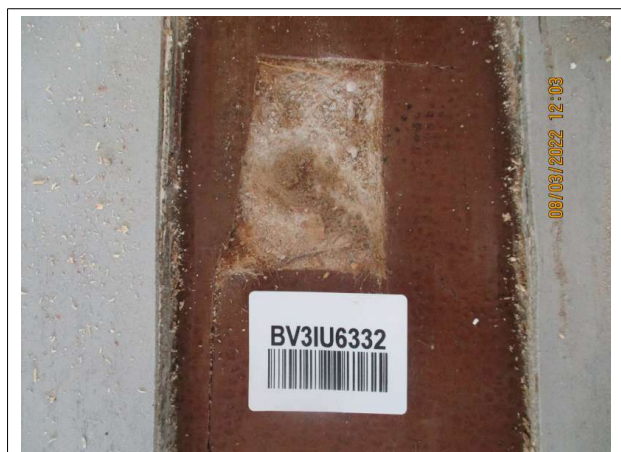
Prélèvement - P005 : Rectorat / 1er Etage / Bureaux inspecteurs - Lé plastique avec sous-couche- (Absence d'amiante)
