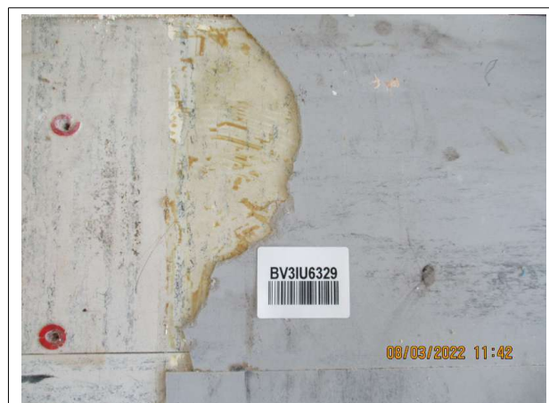
Prélèvement - P002 : Rectorat / 1er Etage / Bureaux inspecteurs - Colle non bitumineuse- (Présence d'amiante)
