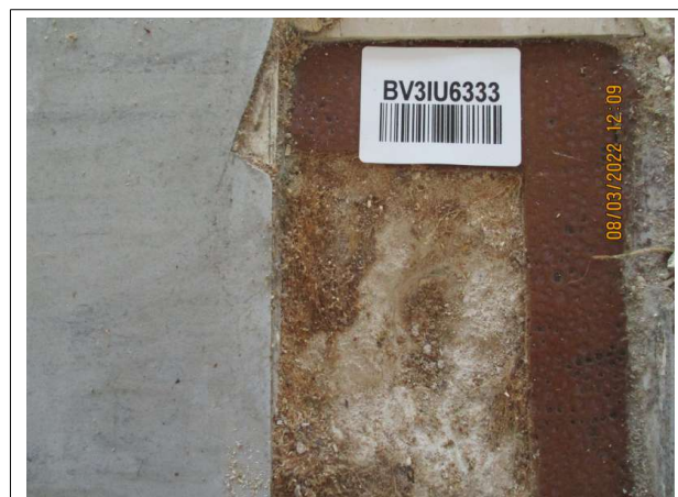
Prélèvement - P006 : Rectorat / 1er Etage / Bureaux inspecteurs - Colle non bitumineuse- (Absence d'amiante)
