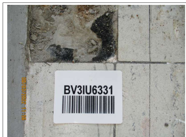
Prélèvement - P004 : Rectorat / 1er Etage / Bureaux inspecteurs - Colle bitumineuse- (Présence d'amiante)
